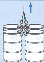
●クランプ4ヶ使用 ドラム缶4本吊り (この場合垂直に吊れます。)
