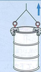
●クランプ2ヶ使用 (鉄粉など重量物を吊り上げ 運搬するとき安全です。)
