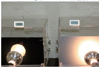
100W レフ電球による照射温度測定
