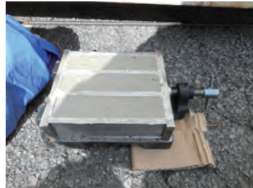
SKY-G1/SKY-CSP60% (W/C)のペースト供試体1日経過。ブリーチングもなく伸縮もなく固化している。
