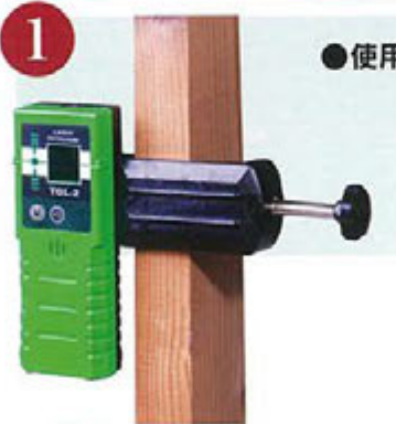
① 水平ライン光を検出します。
